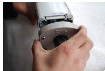
2, 将侧盖拉开, 露出内部接线端子
