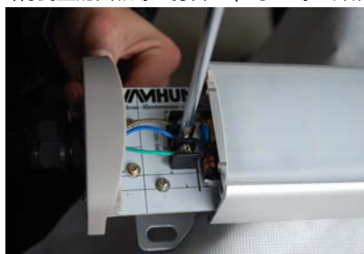
3, 将电源线从防水接头插入, 接在对应的端子上, 参照接线示意图
