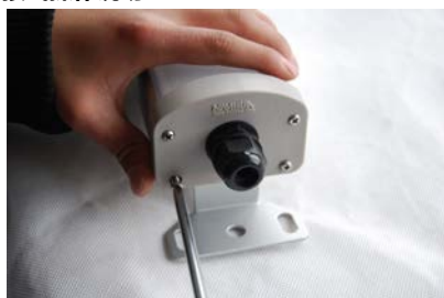
1, 将侧盖的四颗螺丝拧开 (★小心螺丝掉落★)
